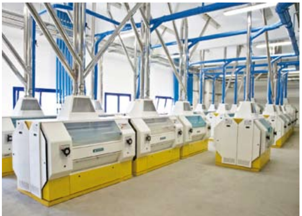
I laminatoi, le macchine che frantumano il chicco di grano e le particelle che da esso si originano.
