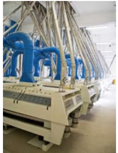
Le semolatrici, classificano le particelle per dimensione, forma e peso specifico.
